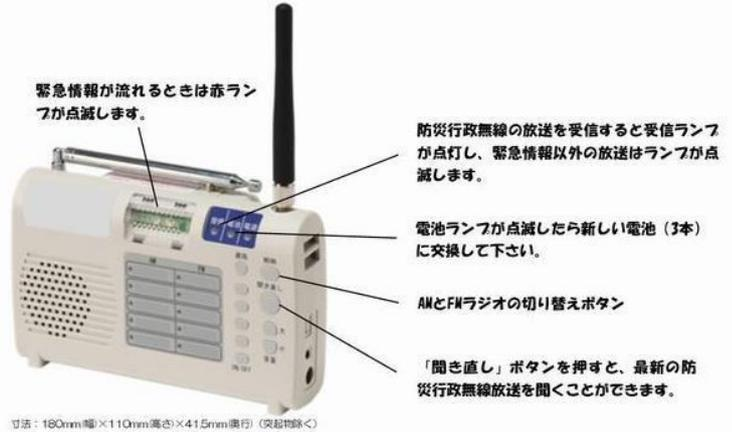
寸法：180mm(幅)×110mm(高さ)×41.5mm(奥行) (突起部除く)
