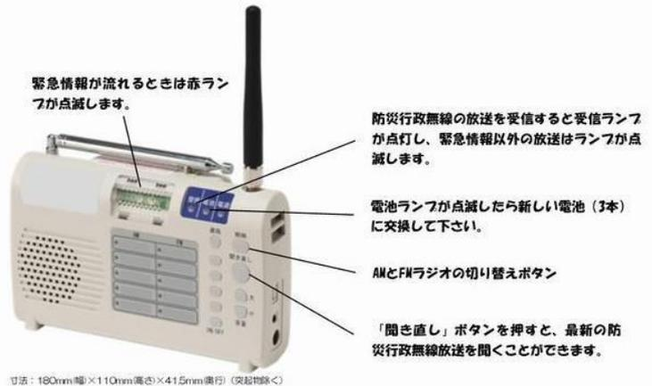
寸法：180mm(幅)×110mm(高さ)×41.5mm(奥行) (突起部除く)
